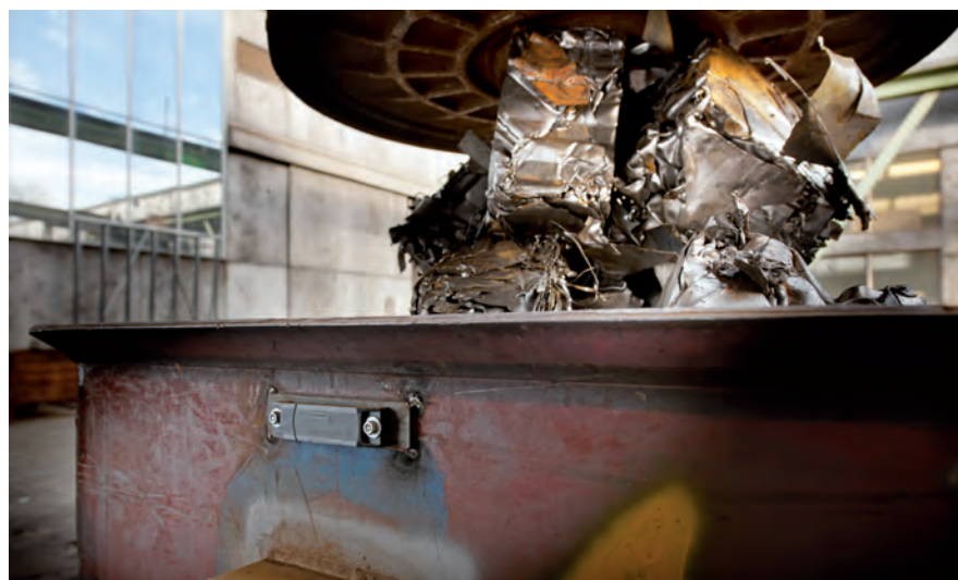
Bild 3: RFID-Transponder Simatic RF680T trotzen sogar den Störfeldern der am Beladekran befestigten starken Elektromagnete
