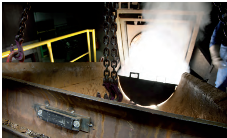
Bild 2: Hitzebeständige RFID-Transponder Simatic RF680T kennzeichnen die Chargierbehälter. Ein starker Metallrahmen schützt sie vor mechanischen Belastungen
