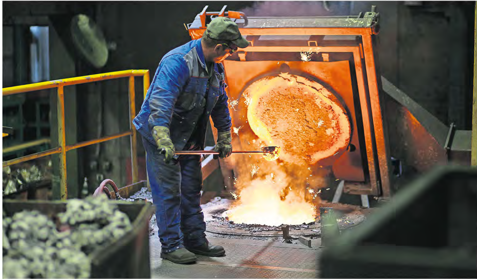
Bei der Firma Casper Guss sind alle Produktionsschritte nachvollziehbar. Hier entnimmt ein Mitarbeiter am Elektroofen eine Probe. Foto: Casper
