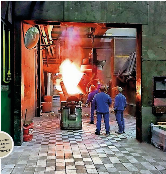
Energieintensiv ist der Betrieb der Nöttinger Gießerei Casper, hier der Schmelzvorgang.
